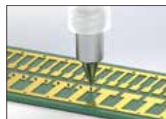
引线框架的焊锡膏涂布
